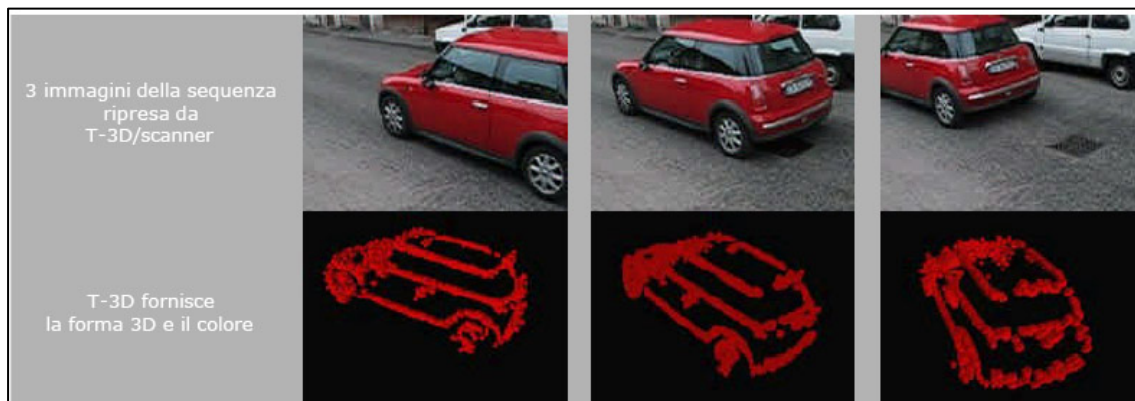
Figura 2 - Funzionamento del sistema T-3D/Scanner
